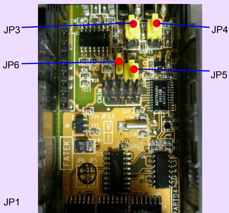
**輸入(A/D)信號設定(電壓或電流設定)**
